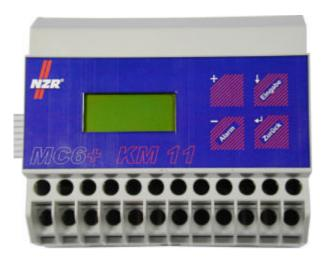
Die Taktzeiten sind an der integrierten Tastatur oder mit den Softwaretypen *WinMC*+ bzw. *WinMC*+ *LP* in Sekunden (1-99) einstellbar.
