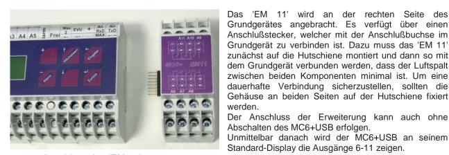
Anschlußstecker, welcher mit der Anschlußbuchse im Grundgerät zu verbinden ist. Dazu muss das 'EM 11' zunächst auf die Hutschiene montiert und dann so mit dem Grundgerät verbunden werden, dass der Luftspalt zwischen beiden Komponenten minimal ist. Um eine dauerhafte Verbindung sicherzustellen, sollten die Gehäuse an beiden Seiten auf der Hutschiene fixiert werden.
