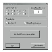
Nach dem Start der Software WinMC+ müssen möglicherweise unter dem Menü 'Optionen' - 'Einstellungen' der ComPort, an welchen der MC6+USB angeschlossen wurde, und die Geräte-Adresse (siehe Abschnitt 3.6) angegeben werden. Dieser Schritt ist normalerweise nur einmal notwendig, da diese Angabe bleibend abgespeichert und bei jedem Neustart eingelesen wird.
